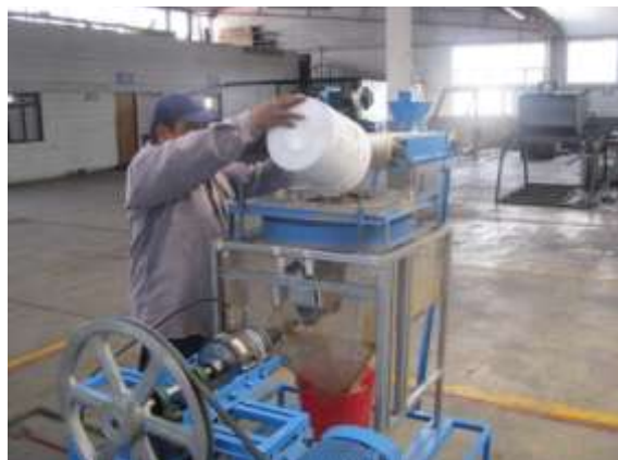
Figura 3. Maqueta experimental para el descascarado de cápsulas de higuierilla ( Ricinus communis L. ).
